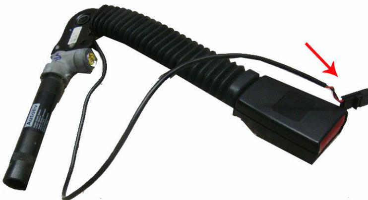
Ziehen Sie dafür die beiden dünneren Leitungen aus dem Stecker und montieren Sie unseren Simulator an die beiden frei gewordenen Stellen. (\*die eingesteckten Verbinder haben kleine Dreiecke auf dem Stecker, diese müssen eingedrückt werden und dabei kann das vorhandene Kabel herausgezogen werden\*)
