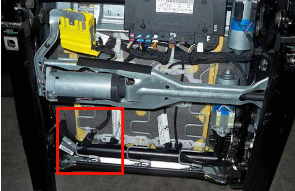
3. Ziehen Sie die abgebildete Steckverbindung auseinander und stecken Sie unseren Simulator in den freigewordenen Stecker.
